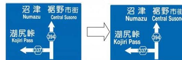
案内標識 (ローマ字の大きさを拡大した例(静岡県))
